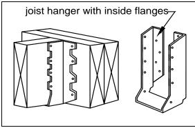
FIGURE 9: TYPICAL JOIST HANGERS
