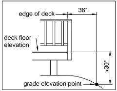
FIGURE 26: WHEN A GUARD IS REQUIRED
