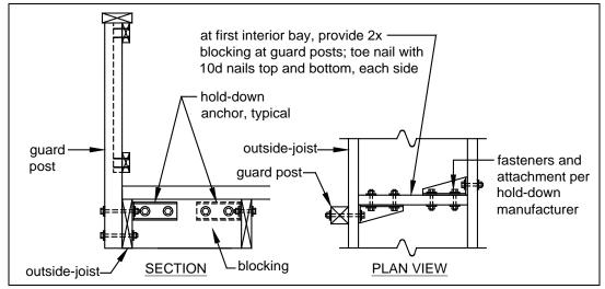
FIGURE 30: GUARD POST-TO-OUTSIDE JOIST DETAIL
