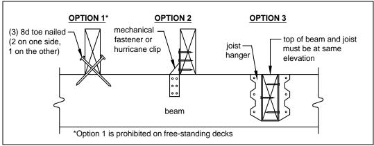
FIGURE 8: JOIST-TO-BEAM DETAIL
