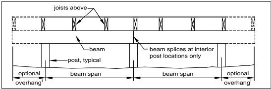
**FIGURE 5: BEAM SPAN TYPES**
